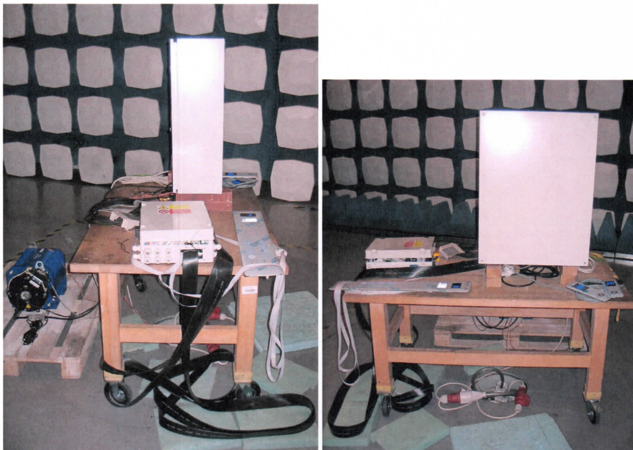
Obr. 13 Uspořádání při měření vyzařovaných emisí
